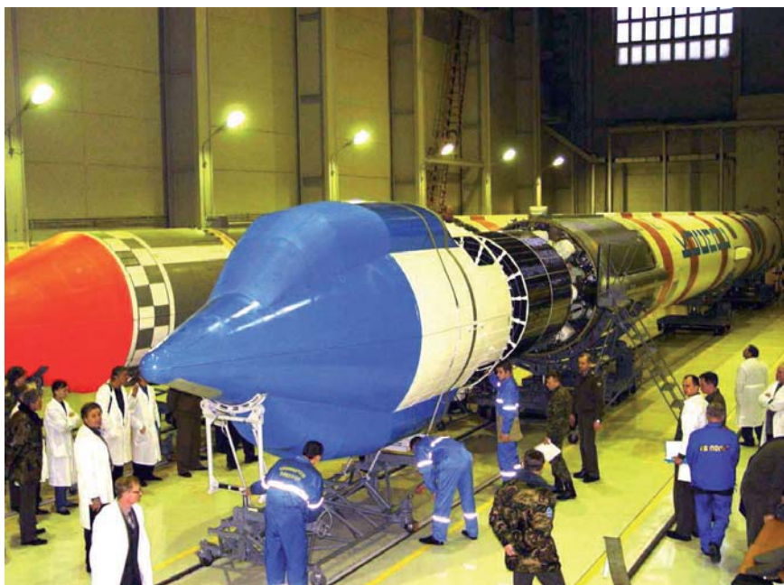
Zur Aufnahme der Radarantenne (Durchmesser 3 m) erhielt der Raketenkopf deutliche Ausbuchtungen
